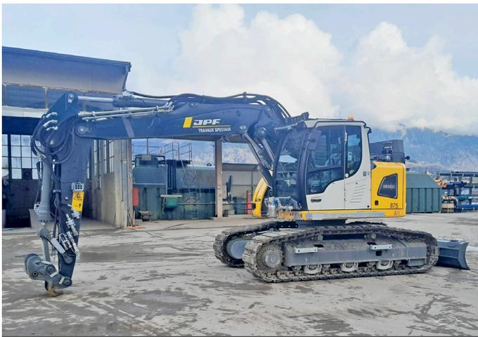
LA PELLEUSE FOREUSE MORATH BB9000 DE JPF TS EST ÉQUIPÉE D'UNE TÉLÉCOMMANDE RADIO PERMETTANT D'OPÉRER SON BRAS HORS DE LA CABINE.
