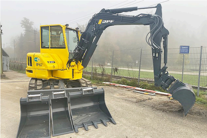
LE CENTRE DE GRAVITÉ BAS ET LE CONTREPOIDS AMÉLIORÉ FONT DE LA PELLE MÉCANIQUE TAKEUCHI TB257FR UNE PLATE-FORME EXTRÊMEMENT STABLE.
