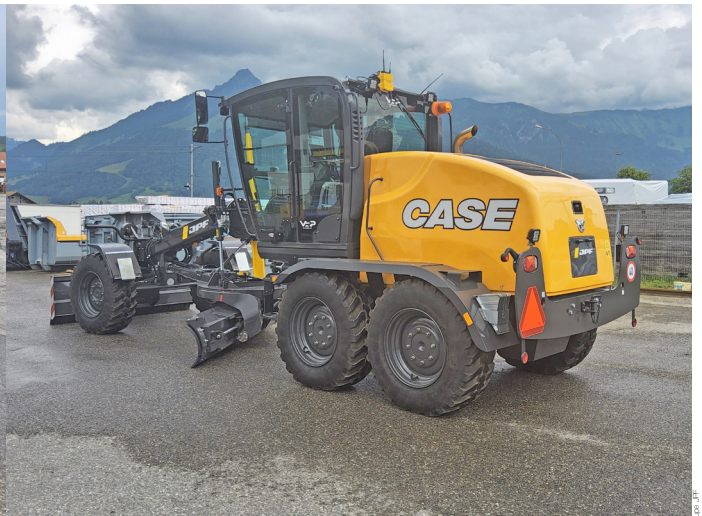
À L'AISE POUR DES TRAVAUX DE TERRASSEMENT, DE NIVELLEMENT, D'ENTRETIEN DE ROUTES AINSI QUE POUR DES APPLICATIONS DANS LES GRAVIÈRES, LA NIVELEUSE CASE 836D EST ÉQUIPÉE D'UN SYSTÈME DE CONTRÔLE ÉLECTRONIQUE QUI RÉGLE LA VITESSE ET LES PARAMÈTRES DE LA LAME AVEC UNE GRANDE PRÉCISION.
