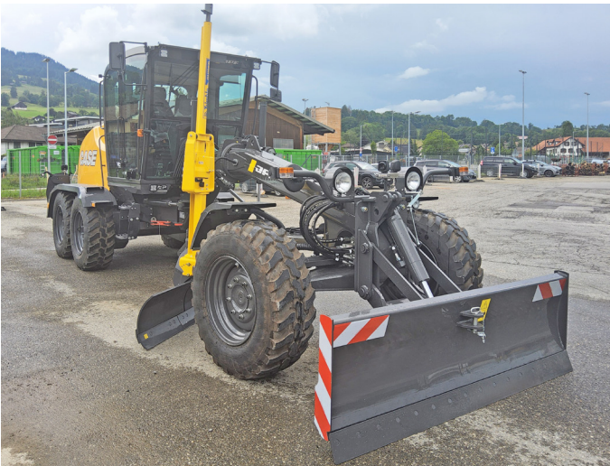
À L'AISE POUR DES TRAVAUX DE TERRASSEMENT, DE NIVELLEMENT, D'ENTRETIEN DE ROUTES AINSI QUE POUR DES APPLICATIONS DANS LES GRAVIÈRES, LA NIVELEUSE CASE 836D EST ÉQUIPÉE D'UN SYSTÈME DE CONTRÔLE ÉLECTRONIQUE QUI RÉGLE LA VITESSE ET LES PARAMÈTRES DE LA LAME AVEC UNE GRANDE PRÉCISION.
